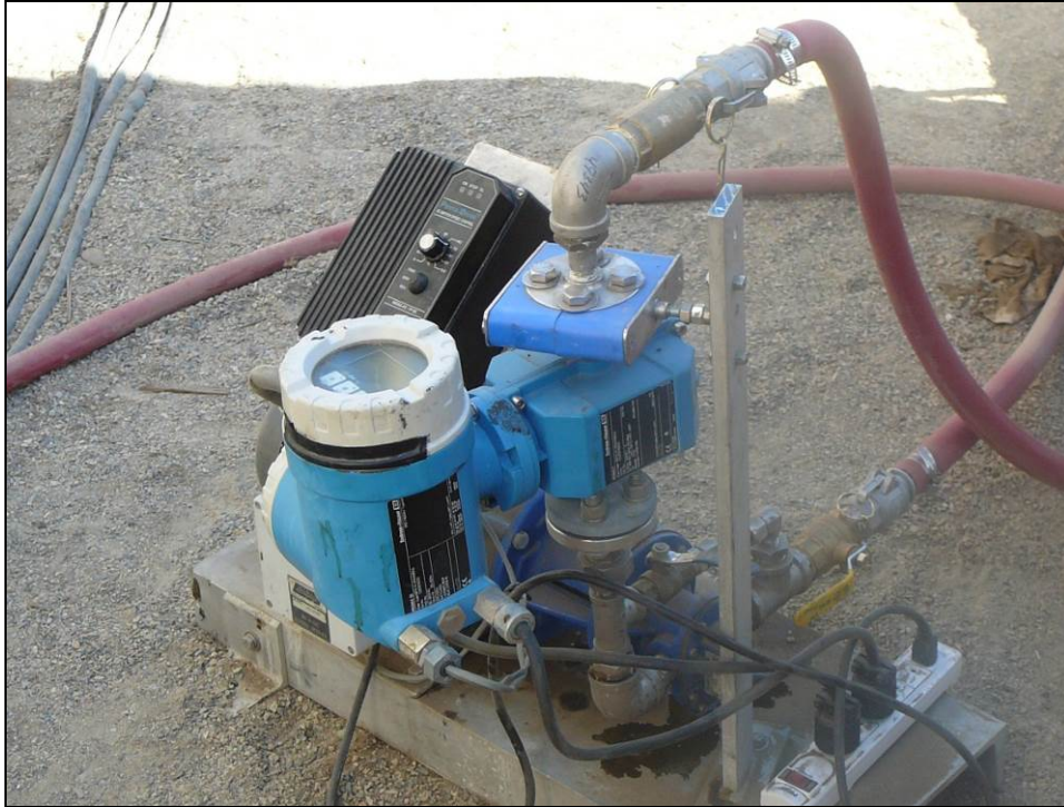
Figure 71 Evotherm DAT Metering System
