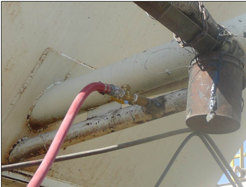
Figure 71 Evotherm DAT Metering System
