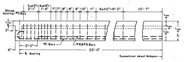
TYPICAL BEAM REINFORCEMENT
